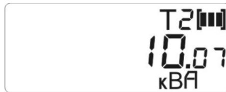
Рисунок Д.16.2 - Пример индикации текущей полной мощности (текущий тариф по активной энергии– 2) (РиМ 181.05-К, РиМ 181.06-К, РиМ 181.09-К, РиМ 181.10-К)
