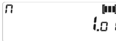
Рисунок Д.4.2 - Пример индикации версии счетчика (РиМ 181.05-К, РиМ 181.06-К, РиМ 181.09-К, РиМ 181.10-К)
