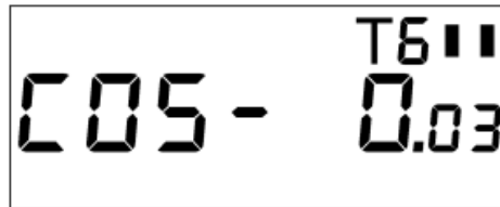
Рисунок Д.19.1 - Пример индикации коэффициента мощности (текущий тариф по активной энергии– 6) (РиМ 181.01-К-РиМ 181.04-К, РиМ 181.07-К-РиМ 181.08-К)
