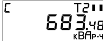
Рисунок Д.8.1 - Пример индикации текущих показаний реактивной энергии (емкостной) (текущий тариф по активной энергии – 2) (РиМ 181.01-К-РиМ 181.04-К, РиМ 181.07-К-РиМ 181.08-К)
