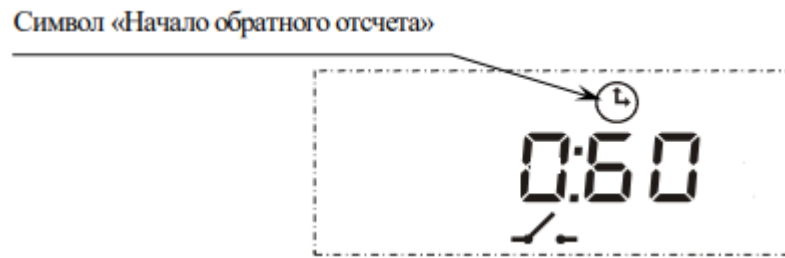
Рисунок Д.36 - Пример индикации символа «Начало отсчета» для РИМ 181.05-К, РИМ 181.06-К, РИМ 181.09-К, РИМ 181.10-К
