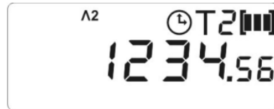
Рисунок Д.28 - Пример индикации показаний счетчика энергоресурса на РДЧ по дискретному входу 2. Единица измерения определяется константой, введенной при конфигурировании счетчика (литры, кубометры или иное) (текущий тариф по активной энергии– 2) (РиМ 181.05-К, РиМ 181.06-К, РиМ 181.09-К, РиМ 181.10-К)
