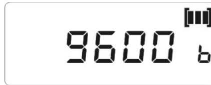
Рисунок Д.6.2 - Пример индикации скорости обмена интерфейса RS-485 счетчика (в примере – 9600 Бод) (РиМ 181.05-К, РиМ 181.06-К, РиМ 181.09-К, РиМ 181.10-К)
