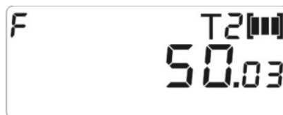
Рисунок Д.20.2 - Пример индикации частоты сети (текущий тариф по активной энергии– 2) (РиМ 181.05-К, РиМ 181.06-К, РиМ 181.09-К, РиМ 181.10-К)
