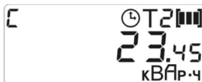
Рисунок Д.11.2 - Пример индикации показаний реактивной энергии (емкостной) за прошедший отчетный период (на РДЧ) (текущий тариф по активной энергии– 2) (РиМ 181.05-К, РиМ 181.06-К, РиМ 181.09-К, РиМ 181.10-К)
