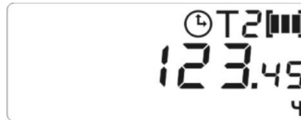
Рисунок Д.13.2 - Пример индикации продолжительности времени подачи некачественной электроэнергии за прошедший отчетный период (на РДЧ) в формате: час – сотых долей часа (текущий тариф по активной энергии– 2) (РиМ 181.05-К, РиМ 181.06-К, РиМ 181.09-К, РиМ 181.10-К)
