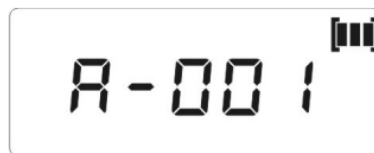
Рисунок Д.5.2 - Пример индикации адреса интерфейса RS-485 счетчика (в примере - 001) (РиМ 181.05-К, РиМ 181.06-К, РиМ 181.09-К, РиМ 181.10-К)
