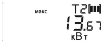
Рисунок Д.24 - Пример индикации максимального значения средней активной мощности на программируемом интервале в текущем отчетном периоде (текущей максимальной интервальной мощности, Ринт макс) (текущий тариф по активной энергии– 2) (РиМ 181.05-К, РиМ 181.06-К, РиМ 181.09-К, РиМ 181.10-К)
