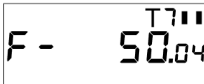
Рисунок Д.20.1 - Пример индикации частоты питающей сети (текущий тариф по активной энергии– 7) (РиМ 181.01-К-РиМ 181.04-К, РиМ 181.07-К-РиМ 181.08-К)
