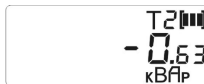
Рисунок Д.15.2 - Пример индикации текущей реактивной мощности (в примере – емкостной, индуктивная мощность отображается без знака) (текущий тариф по активной энергии– 2) (РиМ 181.05-К, РиМ 181.06-К, РиМ 181.09-К, РиМ 181.10-К)
