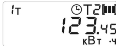
Рисунок Д.27 - Пример индикации показаний активной энергии по 1 тарифу за прошедший отчетный период (на РДЧ) (текущий тариф по активной энергии– 2) (РиМ 181.05-К, РиМ 181.06-К, РиМ 181.09-К, РиМ 181.10-К)
