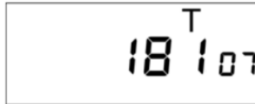
Рисунок Д.3.1 - Пример индикации типа счетчика (РиМ 181.01-К-РиМ 181.04-К, РиМ 181.07-К-РиМ 181.08-К)
