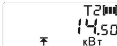
Рисунок Д.30 - Пример индикации установленного порога мощности для отключения нагрузки (УПМк) (текущий тариф по активной энергии– 2) (РиМ 181.05-К, РиМ 181.06-К, РиМ 181.09-К, РиМ 181.10-К)
