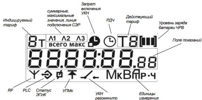
Рисунок Д.1.1 - Расположение полей дисплея счетчика (РиМ 181.05-К, РиМ 181.06-К, РиМ 181.09-К, РиМ 181.10-К)
