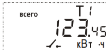
Рисунок Д.35.3 – Пример индикации «УКН разомкнуто» для РиМ 181.05-К, РиМ 181.06-К, РиМ 181.09-К, РиМ 181.10-К
