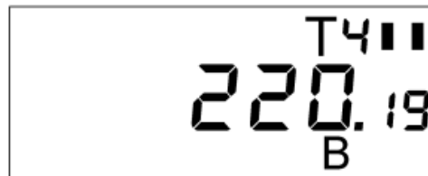
Рисунок Д.17.1 - Пример индикации напряжения сети (текущий тариф по активной энергии– 4) (РиМ 181.01-К-РиМ 181.04-К, РиМ 181.07-К-РиМ 181.08-К)
