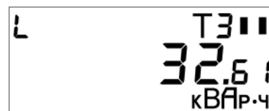
Рисунок Д.9.1 - Пример индикации текущих показаний реактивной энергии (индуктивной) (текущий тариф по активной энергии – 3) (РиМ 181.01-К-РиМ 181.04-К, РиМ 181.07-К-РиМ 181.08-К)
