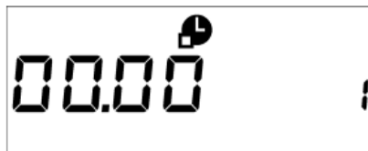
Рисунок Д.23 - Пример индикации даты и времени РДЧ (в примере 00 часов 00 минут 1 числа месяца) (РиМ 181.01-К-РиМ 181.04-К, РиМ 181.07-К-РиМ 181.08-К)
