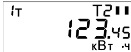
Рисунок Д.7.1 - Пример индикации текущих показаний активной энергии по 1 тарифу (текущий тариф по активной энергии – 2) (РиМ 181.01-К-РиМ 181.04-К, РиМ 181.07-К-РиМ 181.08-К)
