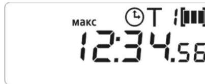
Рисунок Д.33 - Пример индикации времени фиксации Ррдч в формате: час – минут – секунд (текущий тариф по активной энергии – 1) (РиМ 181.05-К, РиМ 181.06-К, РиМ 181.09-К, РиМ 181.10-К)
