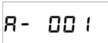
Рисунок Д.5.1 - Пример индикации адреса интерфейса RS-485 счетчика (в примере – 001) (РиМ 181.01-К-РиМ 181.04-К, РиМ 181.07-К-РиМ 181.08-К)
