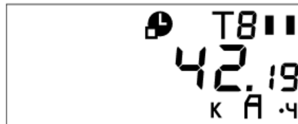
Рисунок Д.13.1 - Пример индикации удельной энергии потерь на РДЧ (текущий тариф по активной энергии– 8) (РиМ 181.01-К-РиМ 181.04-К, РиМ 181.07-К-РиМ 181.08-К)
