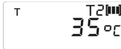
Рисунок Д.34 - Пример индикации температуры внутри корпуса счетчика (текущий тариф по активной энергии– 2) (РиМ 181.05-К, РиМ 181.06-К, РиМ 181.09-К, РиМ 181.10-К)
