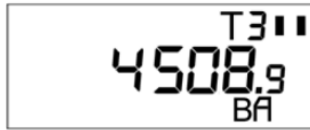
Рисунок Д.16.1 - Пример индикации текущей полной мощности (текущий тариф по активной энергии– 3) (РиМ 181.01-К-РиМ 181.04-К, РиМ 181.07-К-РиМ 181.08-К)
